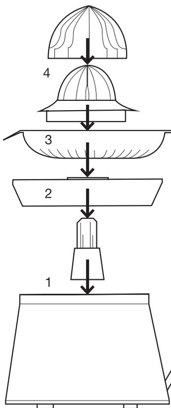
1. Glissez le support de filtre amovible sur l'axe rotatif du bloc moteur.
